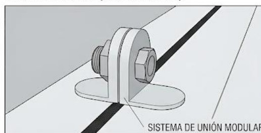
DETALLE DE UNIÓN (VISTA INTERIOR)
